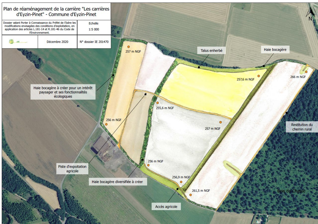
Figure 18 : Extrait de l'annexe 2 de l'arrêté préfectoral complémentaire n°DDPP-DREAL U38-2021-07-21 du 22 juillet 2021 présentant le plan et des schémas de réaménagement à échéance de l'arrêté préfectoral soit au 24 décembre 2027.
